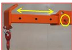
Schuif de verstelbare balken links en rechts in de koker van het ophanggedeelte van het werktuig totdat de juiste instelling in verhouding tot de afmetingen van de te behandelen producten of materialen bereikt is.
