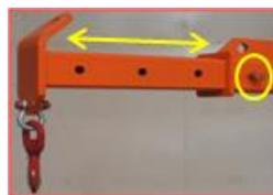
Faites glisser les barres réglables à gauche et à droite dans le manchon de la pièce de fixation de l'outil jusqu'à ce que le réglage correct soit atteint par rapport aux dimensions des produits ou matériaux à traiter.
