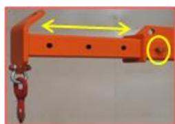
Schieben Sie die einstellbaren Stangen nach links und rechts in die Hülse des Befestigungsteils des Geräts, bis die richtige Einstellung in Bezug auf die Abmessungen der zu behandelnden Produkte oder Materialien erreicht ist.
