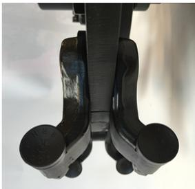
**IMPORTANT:** *Les supports doivent toujours être remplacés par paire en diagonale afin de maintenir l'équilibre du disque.*
