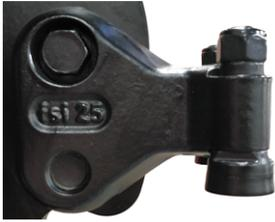
La dent peut pivoter ( $3 \times 120^\circ$  de la surface d'usure). Afin de garantir une coupe optimale, assurez-vous que toutes les dents sont tranchantes. Les supports doivent être solidement fixés dans leur position correcte. Si un support est manquant ou usé, la dent ne peut pas être ajustée correctement et le support doit être remplacé.
