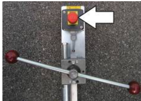
Afb. 13 b: NOODSTOPschakelaar (pijl) aan de afstandsbediening (optioneel).
