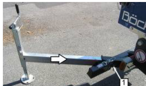
Afb. 36: Achterste steunen plaatsen
