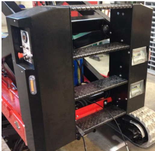
13. Trapje voor de toegang tot het platform
