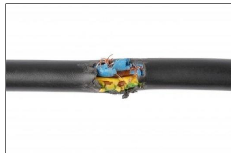
Beschadigde elektrische kabel
