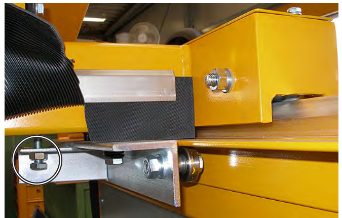
Face inférieure du chariot de coupe, vis de réglage avec contre-écrou côté volant à main, face arrière de la scie à table
