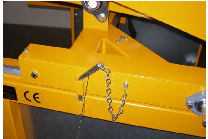
Chariot de coupe bloqué par un boulon de sécurité
