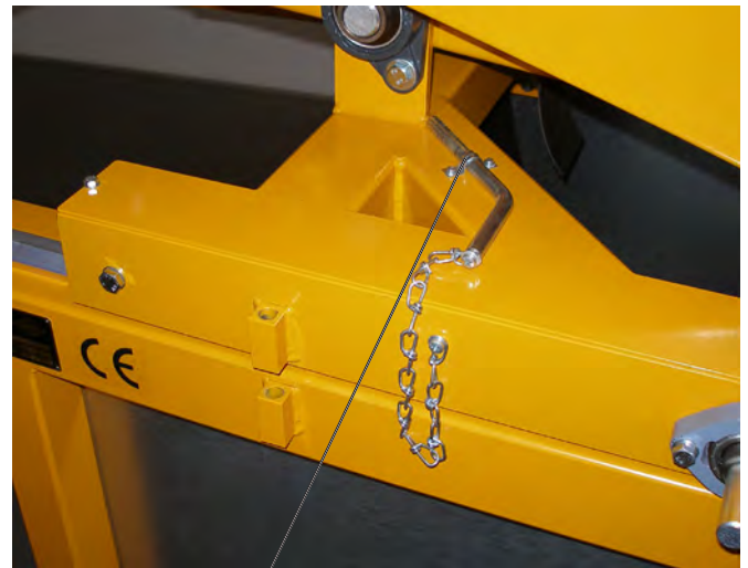
Boulon de sécurité à l'intérieur de son support, chariot de coupe mobile
