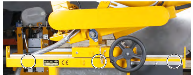
Vis à six pans creux du rail de guidage du chariot de coupe
