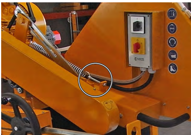
Vis à six pans creux du rail de guidage du chariot de coupe
