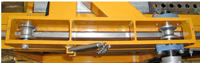
Galets avant et arrière du chariot de coupe (couvercle retiré)
