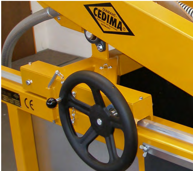
Chariot de coupe, vue sur le volant à main avec le galet avant
