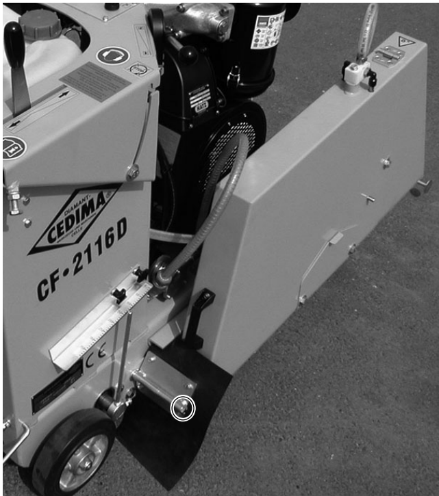
Afbeelding 4.24 CF-2116 D Standaard, Spuitbeschermingsrubber gemonteerd (bevestigingschroef)
