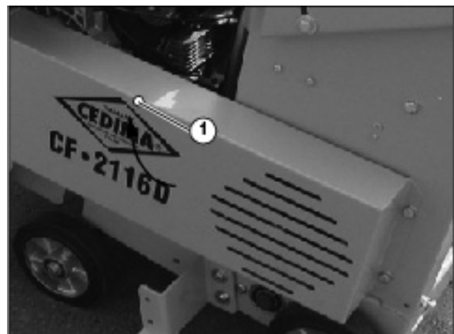
Afbeelding 4.39 CF•2116 D Standaard, bladbeveiligings-slang ① van de rechts gemonteerde bladbeveiliging (diamantzaagblad)
