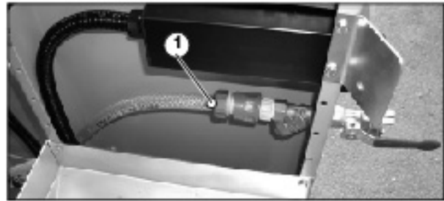
Afbeelding 4.37 CF•2116 D, waterreservoir verwijderd, bladbeveiligings-slang ① van de druk-aansluiting loskoppelen
