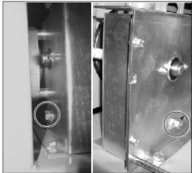
Afbeelding 6.20 Behuizing voortstuwingsdrijfwerk, zicht op de linker en rechter moer van het kettingspanwiel
