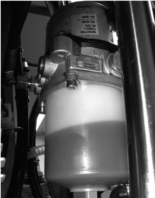
Afbeelding 6.12 Het peil van de hydraulische vloeistof in de transparante verzameltank van het elektro-hydraulische compacte aggregaat bij de CF•2116 D
