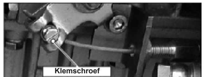
Afbeelding 6.25 CF-2116 D, toerentalhendel met bowdenkabel aan de motor
