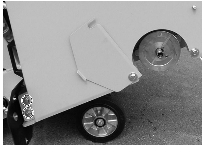
Afbeelding 4.26 Bladbeveiligings-bevestigingsschroeven aan de rechterkant van de CF-2116 D Standaard
