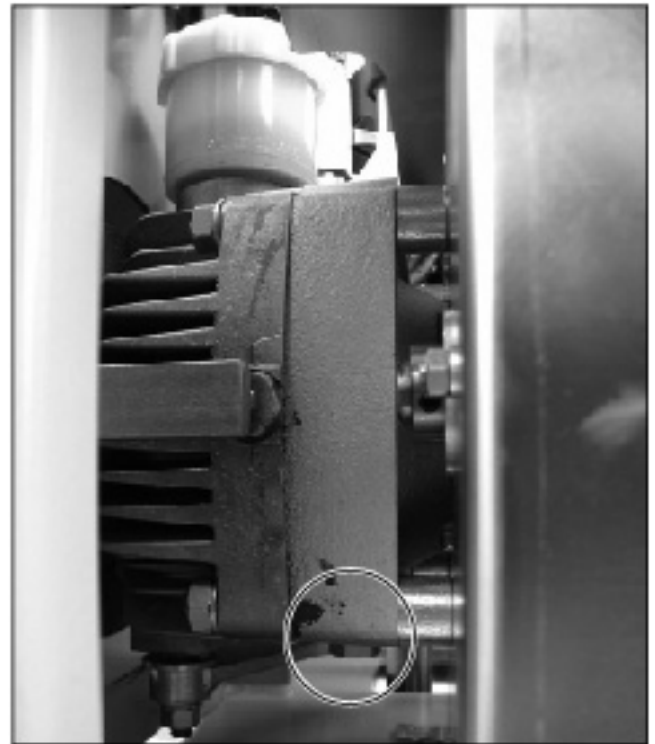
Afbeelding 6.10 CF•2116 D, olieaftapschroef onder het hydrostatische voortstuwingsdrijfwerk
