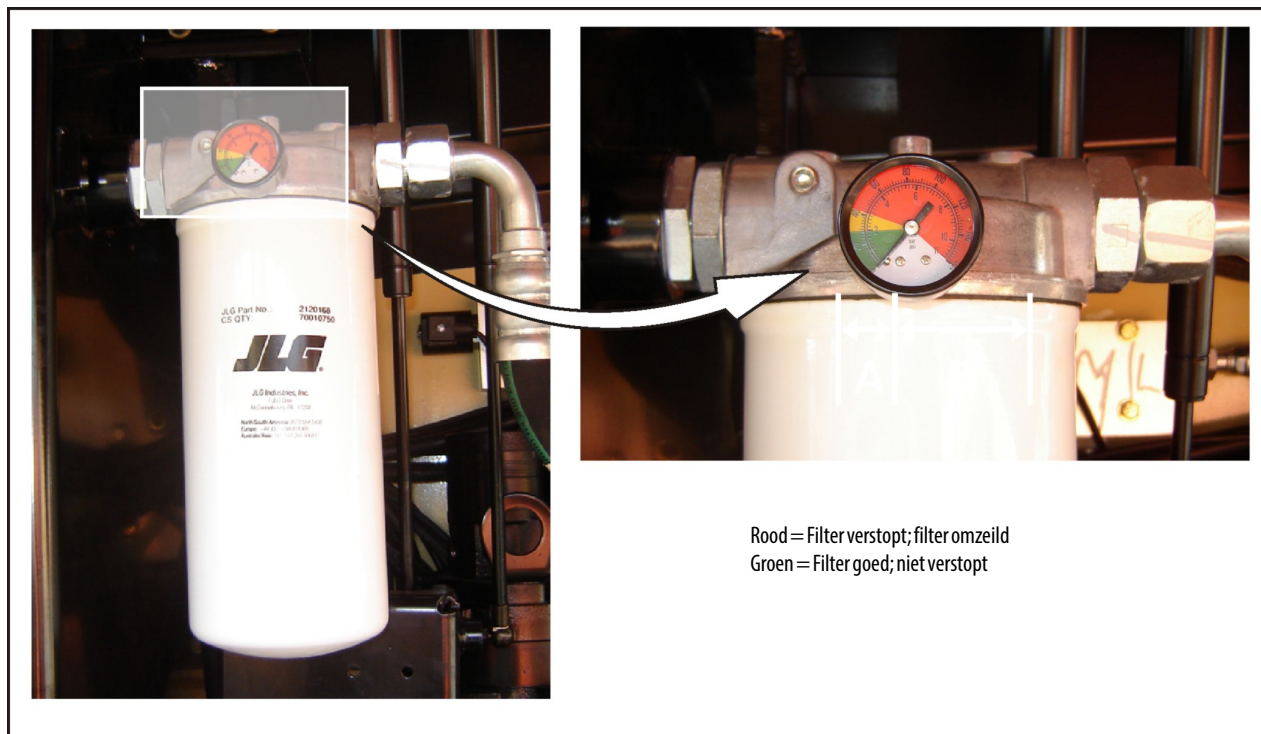
Figuur 6-8. Toestandindicator hydrauliekoliefilter - S/N 139396 tot heden
