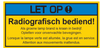
Figuur 36; signalering radiografisch in bedrijf.
