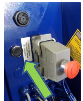
Figuur 4; Drukknop t.b.v. Overbrugging Hijs-eindafslag.
