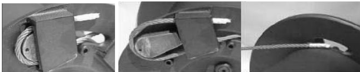
Figuur 63; Spie bevestiging lierkabel.
