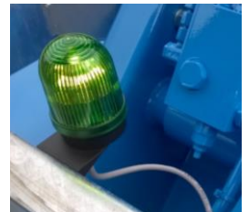
Figuur 36; signalering radiografisch in bedrijf.
