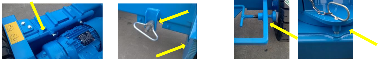
Figuur 55; Smeren van handels, spindels en borgingen.
