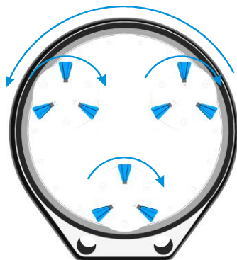
Figuur 4-1 Illustreert de rotatie van de schuurkoppen versus de draaischijf.
