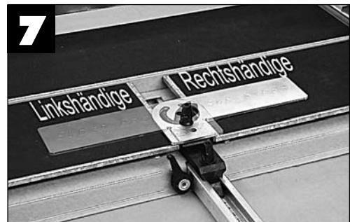
**UM DEN WINKELHALTER KORREKT AUF 90° ZU STELLEN, DIESEN AUF DIE MITTE DES SCHNEIDERANDS DES ARBEITSTISCHES AUSRICHTEN, BEVOR DER FESTSTELLKNAUF WIEDER ANGEZOGEN WIRD.**
