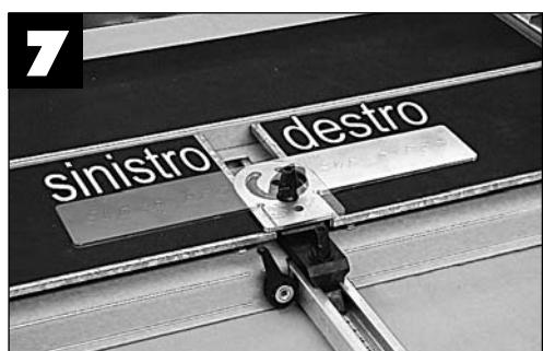
**PER OTTENERE UN CORRETTO POSIZIONAMENTO A 90° DELLA SQUADRETTA, ALLINEARLA AL CENTRO DELLA COSTA DI TAGLIO DEL PIANO DI LAVORO PRIMA DI SERRARE IL POMELLO DI BLOCCAGGIO.**
