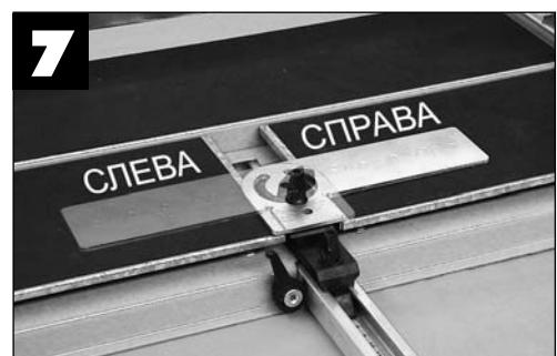
для того, чтобы получить правильную установку под углом в 90° угольнику, выравнять его по центру режущей направляющей рабочей плоскости перед тем, как прикручивать блокирующую рукоятку.
