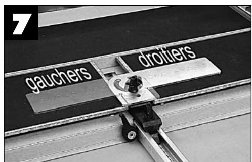
**POUR OBTENIR UN POSITIONNEMENT CORRECT DE L'ÉQUERRE À 90°, L'ALIGNER AU CENTRE DE LA LIGNE DE COUPE DU PLAN DE TRAVAIL AVANT DE SERRER LE POMMEAU DE BLOCAGE.**
