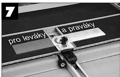
**PRO ZARUČENÍ PŘESNÉHO UMÍSTĚNÍ ÚHELNÍKU NA 90° JE TŘEBA JEJ VYROVNAT DO STŘedu ŘEZNÉ LINIE NA PRACOVNÍ DESCE A POTÉ UTÁHNOUT POJISTNÝ ŠROUB.**
