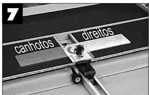
PARA OBTÉR UM CORRECTO POSICIONAMENTO A 90° DO EQUADRO, ALINHÁ-LO NO CENTRO DA BASE DE CORTE DA BANCADA DE TRABALHO ANTES DE FIXAR O MANÍPULO DE BLOQUEIO.
