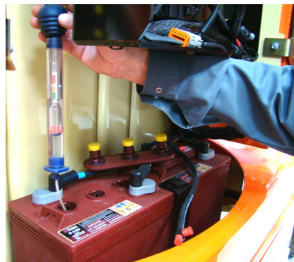
Figuur 5-8. Het soortelijk gewicht van de elektrolyt meten
