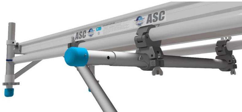
9. Fixez le support mural télescopique à l'aide des raccords aux deux renforts horizontaux. Veillez à ce que la tête soit poussée contre le mur. Si vous disposez de deux murs, faites glisser le tube télescopique le plus loin possible.
