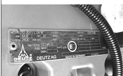
afb. 2: Typeplaatje Deutz-dieselmotor vanaf serienummer AD.....
