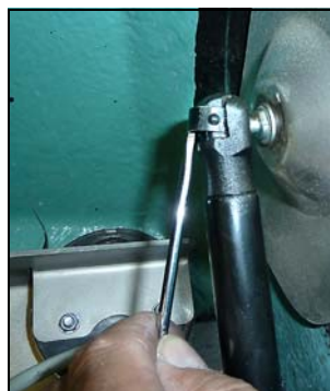
Fig. 10-9 Hef met een schroevendraaier de klemmen op, en los de veer
