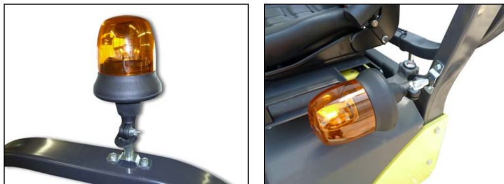
Fig. 8-4 Waarschuwingslamp in bedrijf / buiten bedrijf
