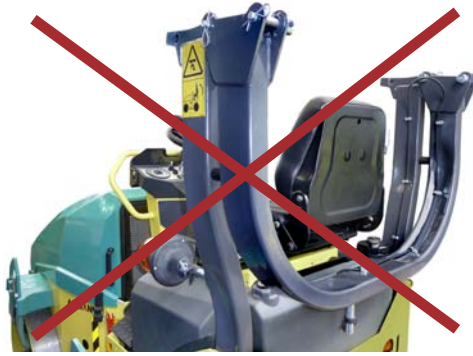
Fig. 3-2 ROPS in bedrijf niet naar onder klappen
