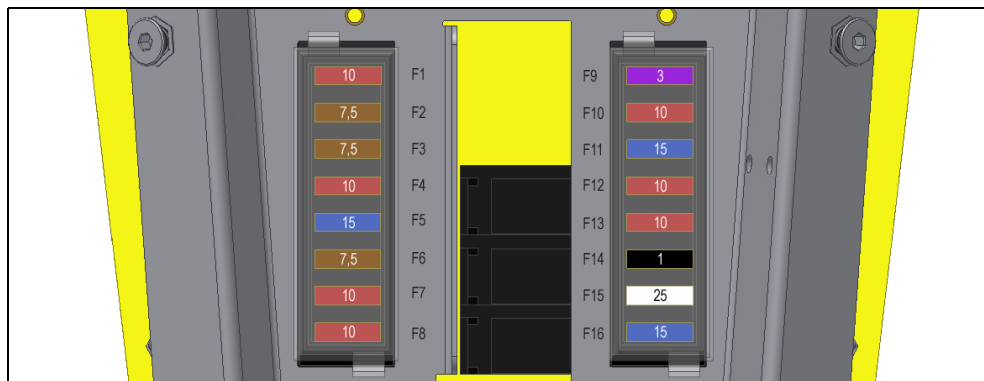
Fig. 10-5 Positie van de zekeringen in de stuurkolom
