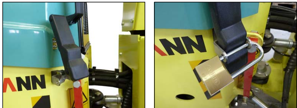
Fig. 9-4 Spansluiting open / Spansluiting gesloten
