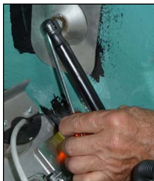
Fig. 10-9 Hef met een schroevendraaier de klemmen op, en los de veer
