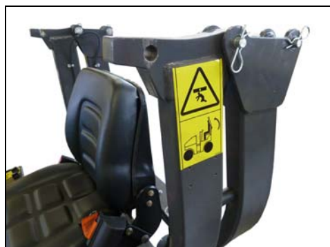
Fig. 7-1 ROPS onder / ROPS boven
