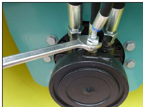
Fig. 9-31 Remslang demonteren en drukveilig afsluiten.
