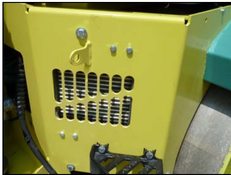
Fig. 9-16 Rooster koeler hydraulische olie
