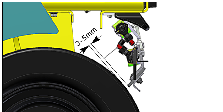
Fig. 9-26 Afstand schraper tot bandwielas
