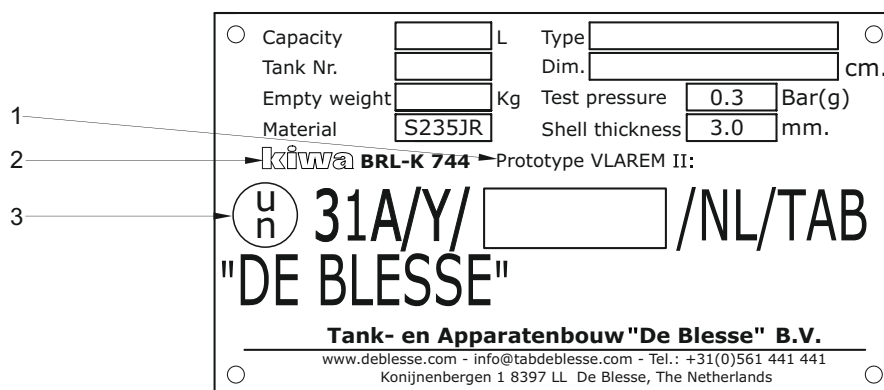
Afbeelding A.3 Naamplaat / Illustration A.3 Nameplate / Illustration A.3 Plaquette signalétique / Abbildung A.3 Typenschild
