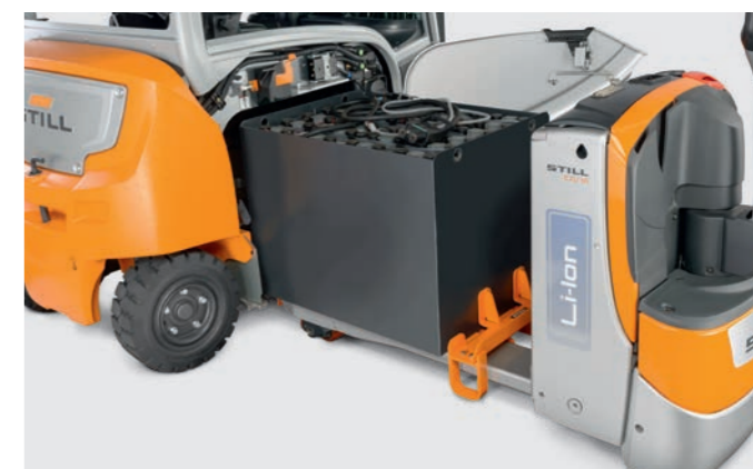
Batterij verwisselen met elektrische pallettruck
